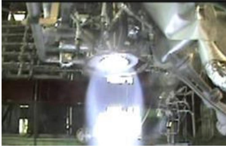
図 11.7-6 LNG エンジン燃焼試験
