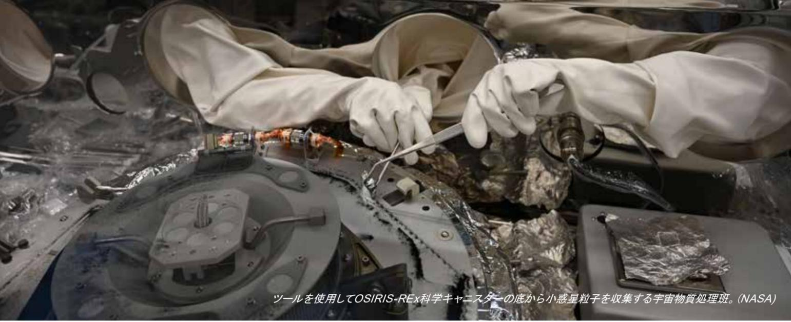
ツールを使用してOSIRIS-REx科学キャニスターの底から小惑星粒子を収集する宇宙物質処理班。(NASA)
