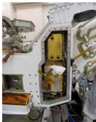
パーシビアランス・ローバーに組み込まれた金色のRimfaxe電子機器ユニット。(NASA)
