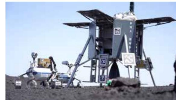
2022年、エトナ山でのARCHES類似環境ミッション中、協力ミッションシナリオでランダーからモジュール式ペイロードを回収する2台のLightweight Rover Unit (LRU)
