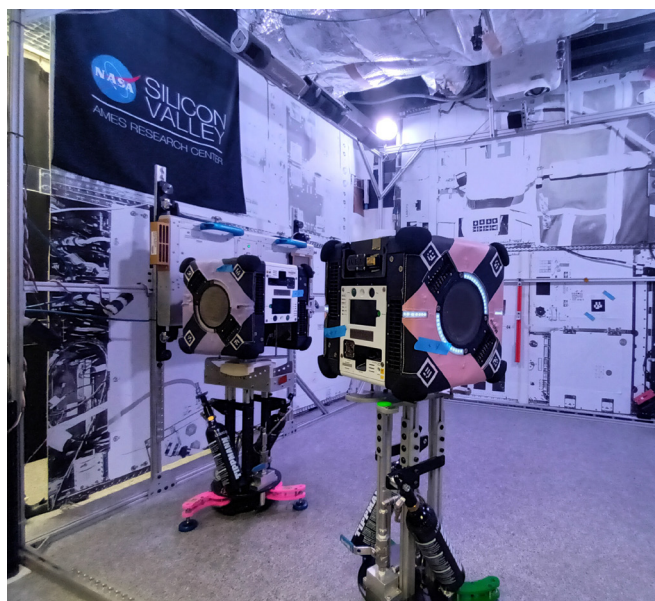
NASAエイムズ研究センターの模擬ISS環境でAstrobeeロボットプラットフォームに取り付けられたCSIROのmulti-resolution scanning payload。(CSIRO)
