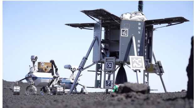
2022年、エトナ山でのARCHES類似環境ミッション中、協力ミッションシナリオでランダーからモジュール式ペイロードを回収する2台のLightweight Rover Unit (LRU)
