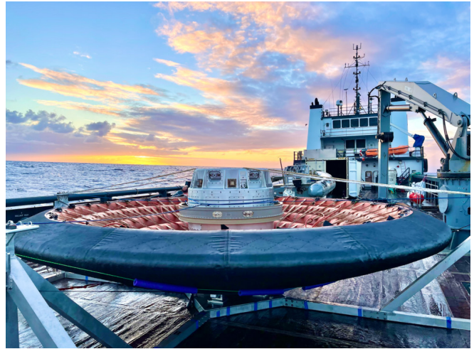
2022年11月、回収船に乗った地球低軌道飛行試験で火星の飛行条件の再現に成功した6m膨張式減速機 (NASA/Gregory Swanson)
