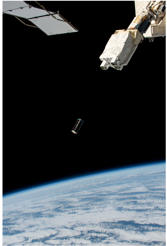
日本実験棟「きぼう」小型衛星放出機構から放出された原田精機株式会社が開発したHSKSAT。(JAXA)
