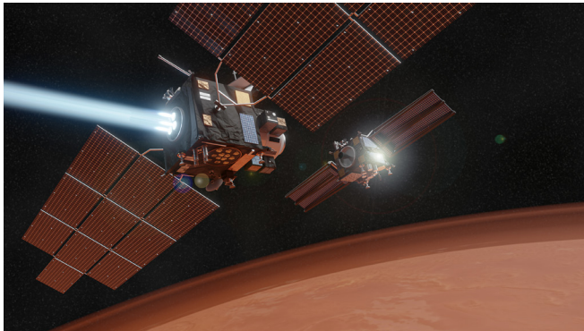
ESAのLightShipコンセプト:通信及びナビゲーションサービスや科学ペイロードを含む、地球帰還オービターの技術を基に構築された火星推進牽引機能。LightShipは、複数の科学的な有人オービターも火星に運びます。(ESA)
