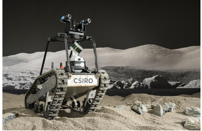
CSIROの資源のその場利用施設には、月面の物理的特性の一部をシミュレートして、ローバーや関連機器などのアセットの現実的な試験と評価を行う月面テストベッドがあります。(CSIRO)
